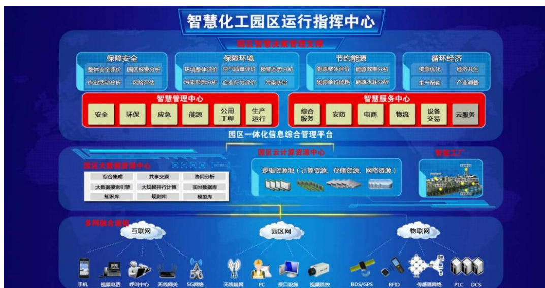
图 1 智慧园区一体化管控平台架构
