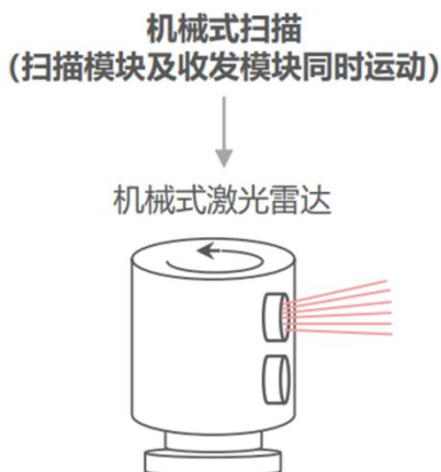
图 12：机械式激光雷达原理示意图
