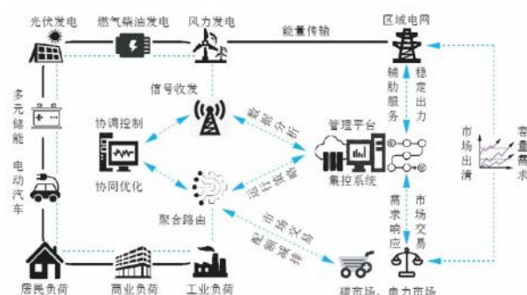
图 27 虚拟电厂结构示意图 18
