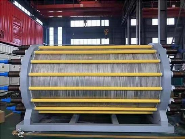
图表 5: 电解槽设备主体一览
