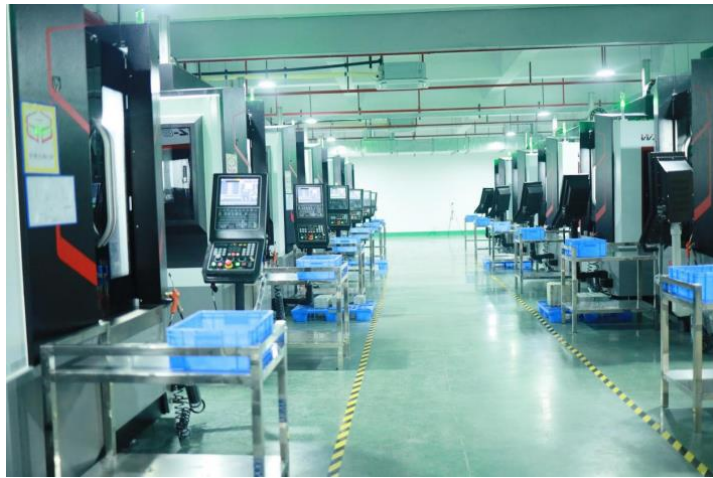
图表61: 采用华中数控系统的全直驱五轴数控加工中心
