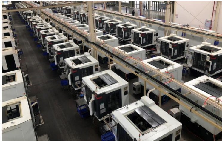
图表60: 批量配置华中8型系统和直线电机的高速钻攻中心
