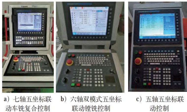
图63: HNC848 配套不同构型五轴机床
