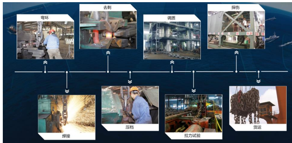
图：系泊链从弯环到货运的流程
