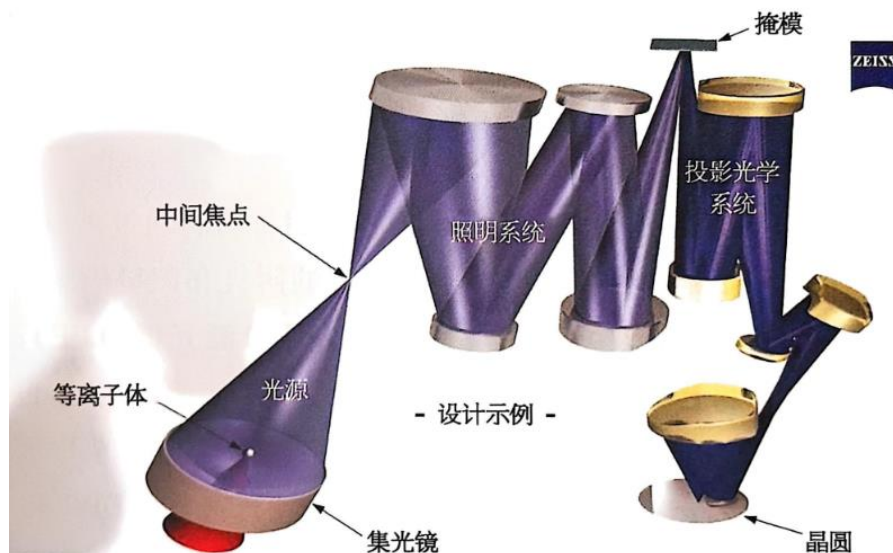
图表 46 EUV 光刻的蔡司成像系统示意
