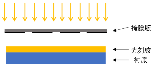
图表 28 接近式光刻示意图
