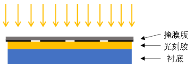
图表 27 接触式光刻示意图
